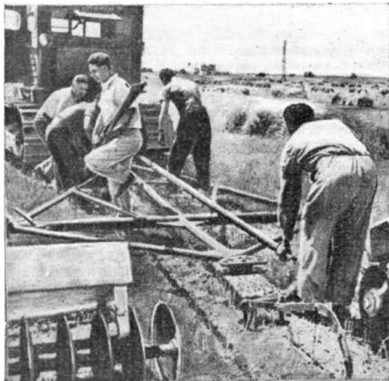
Сотрудники научно-исследовательского института в Паненских Бржезанах Хаврской МТС сконструировали культиватор с захватом 7—10 метров.
